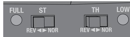
Ermöglicht das Reversieren (umdrehen) der Steuerrichtung (ST.REV) und des Gaskanal (TH REV). Die Werkseinstellungen für die Steuerung und Gas ist "R"
