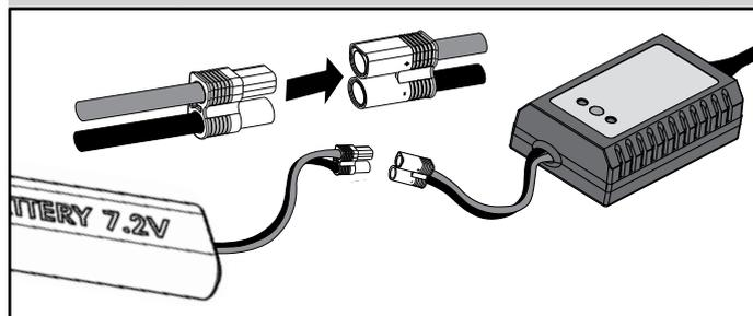
Das Ladegerät lädt mit 2,0A (2000 mAh) per Stunde. Dividieren Sie die auf dem Akkuetikett angegebene mAh Kapazität durch 2000 um die erforderliche Ladezeit zu errechnen. So benötigt zum Beispiel ein 1800mAh Akku 0,9 Stunden = 54 Minuten zum laden.
